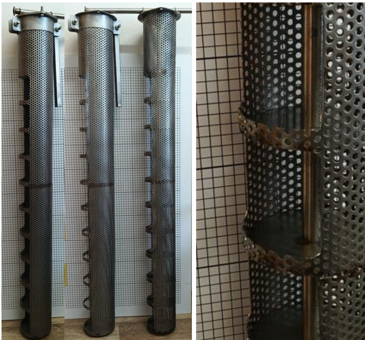
Obr. 7 Vzorkovač agropelet (vlevo sestava vzorkovače, vpravo vnitřní odběrová nádoba)
